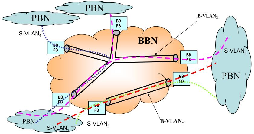
• BB PB: Backbone Provider Bridge Edge
