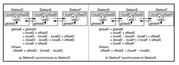
Figure 7.5—Time synchronization principles
