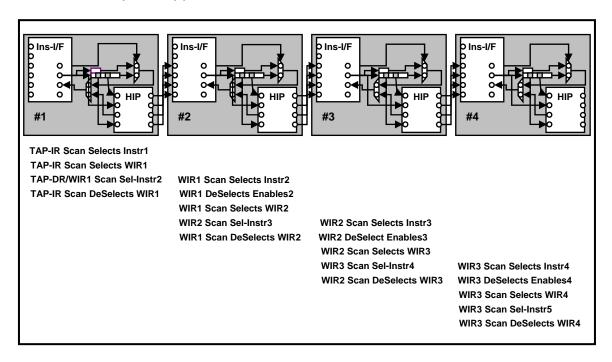
Figure B-5: An example Hierarchical-Access Protocol-Explosion
