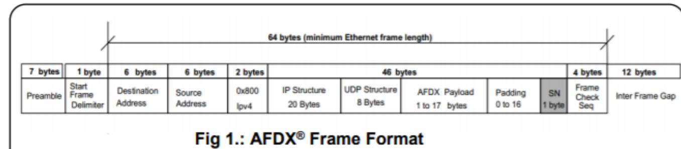
Fig 1.: AFDX<sup>®</sup> Frame Format
